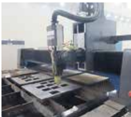
NCレーザー切断機(12KW)
