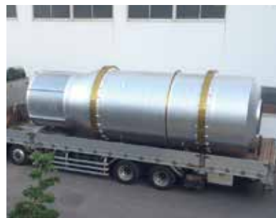
砂処理炉設備
