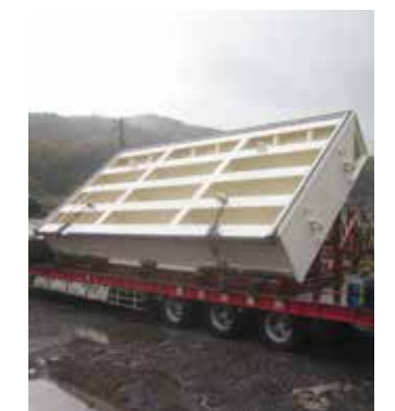
某原子力 防潮扉
