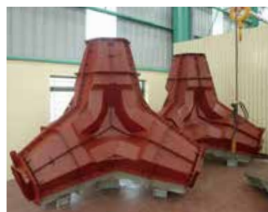
コンクリート型枠
