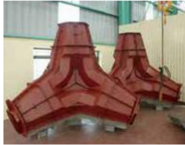
コンクリート型枠
