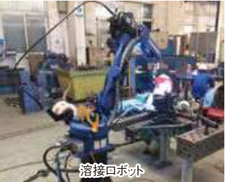
溶接ロボット
